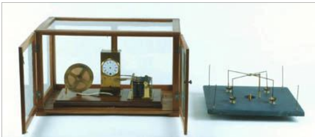
Fig. 4 Protosismografo De Rossicostruito da Ermanno Brassart nel 1878
