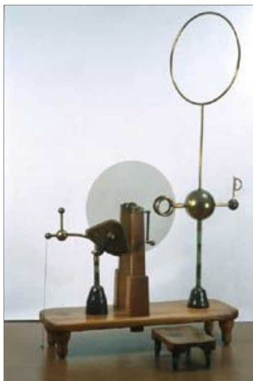
Fig. 3 Grande macchina elettrostatica a disco di Winter costruita da Achille Scateni nel 1863
