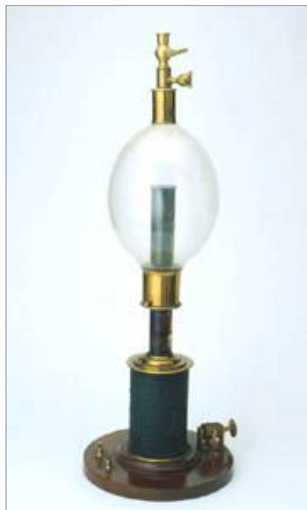
Fig. 5 Uovo elettrico di de la Rive acquistato dal Serpieri a Parigi nel 1865
