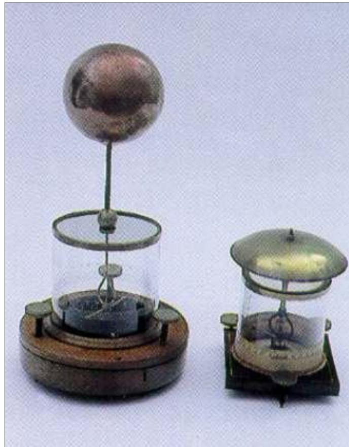
Fig. 8 Coppia di elettrometri atmosferici di Peltier. Fornivano qualitativamente la quantità di elettricità presente nell'aria.
