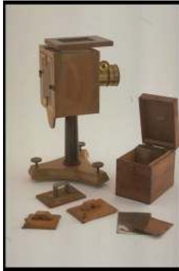
Fig. 4 Dagherrotipo con lastre fotografiche ed accessori per pulirle. Fu acquistato dal Serpieri nel 1847 a Senigallia.
