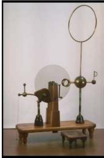
Fig. 3 Grande macchina elettrostatica di Winter costruita da Achille Scateni nel 1863.
