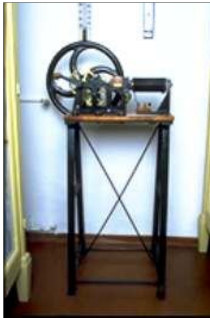
Fig. 6 Apparecchio di Foucault per lo studio delle correnti indotte. Lavorata dal meccanico napoletano Filippo de Palma questa macchina arrivò in Urbino nel 1873.
