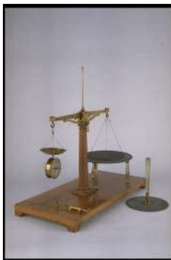
Fig. 12 Bilancia elettrostatica ideata dal fisico Giovanni Cantoni (1818-1897) e commercializzata dalla ditta Tecnomasio. Fu acquistata nel 1870.
